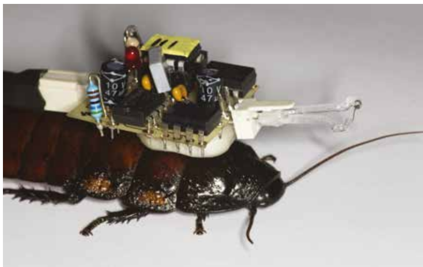
Blatte de Madagascar porteuse d'un dispositif miniaturisé d'« électroantennographie ». Ce dispositif permet de recueillir l'activité électrique d'une antenne de papillon pendant que la blatte se déplace. On peut ainsi étudier la locomotion de la blatte lorsque celle-ci entre ou sort d'un champ odorant - Cliché M. Renou - INRA
