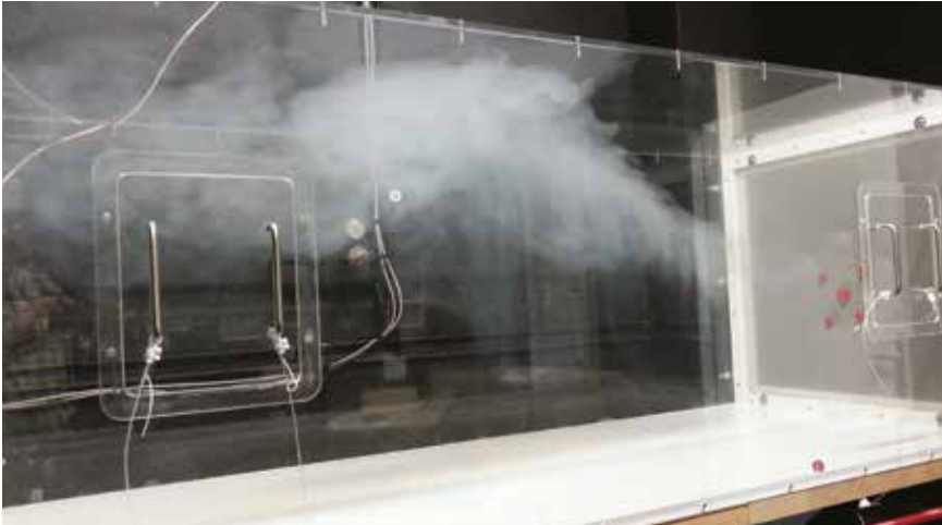
Tunnel de vol pour l'étude de la Noctuelle ipsilon. La fumée permet de visualiser le panache d'odeurs - Cliché M. Renou - INRA
