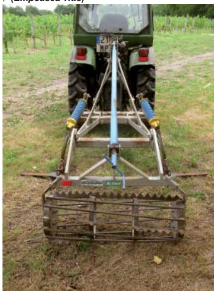
À gauche, outil pour travailler le sol sans labour. À droite, l'enherbement des rangs empêche l'érosion sur les pentes.
