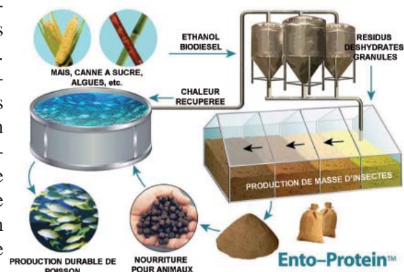
Schéma de recyclage de déchets agricoles et fabrication de farines d'insectes destinées à l'alimentation du poisson (Ento-Protein™) par la société AquaBiologics
